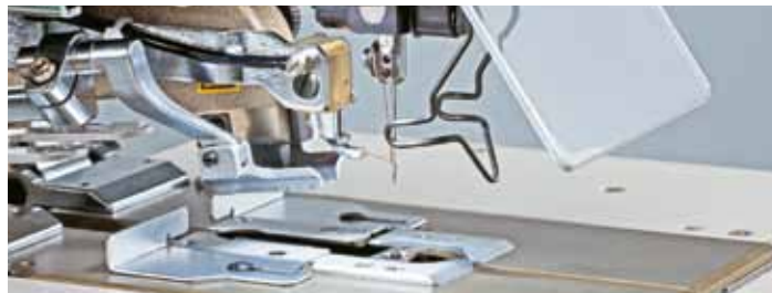
Foto: presenza del meccanismo pinzatore filo dell'ago (opzionale)
